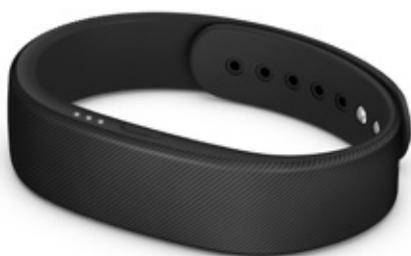
**Los brazaletes RFID** operan de forma parecida a los sistemas de picking por luz o picking por voz. Cuando un empleado llega a un recipiente de piezas, el sistema genera automáticamente un pitido de aviso de que se ha tomado la pieza correcta. Si se toma la pieza equivocada, habrá un doble pitido. También permiten que el operario trabaje con ambas manos. Esta tecnología es una alternativa viable a las gafas de datos 3D.
